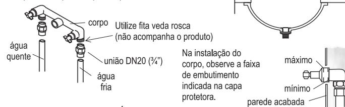
Utilize fita veda rosca (não acompanha o produto) na instalação do corpo, observe a faixa de embutimento indicada na capa protetora.
