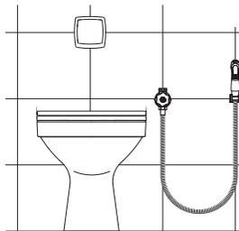
Coloque o parafuso superior com folga para permitir o encaixe do suporte. Em seguida posicione o suporte, fixando-o com o parafuso inferior.
