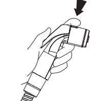
Para interromper o fluxo, aperte a alavanca para liberar o botão, soltando-a em seguida.
