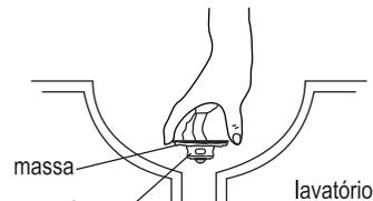
2 Coloque a porca e a guarnição pela parte inferior do lavatório, fixando-a, por cima com o parafuso e com o distanciador montado.
