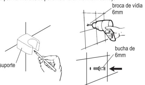
Em seguida posicione o suporte e marque o furo inferior, retire o suporte e faça a furação. Por último encaixe o suporte fixando-o com o parafuso inferior.
