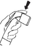
Para interromper o fluxo, aperte a alavanca para liberar o botão, soltando-a em seguida.
