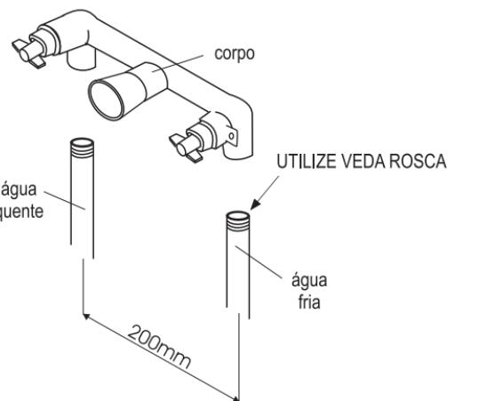
**2** Na instalação do corpo, observe a faixa de embutimento indicada na capa protetora.
