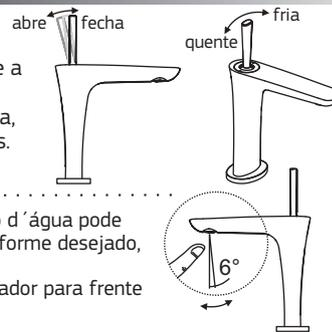
A direção do jato d'água pode ser ajustada conforme desejado, para tanto basta posicionar o arejador para frente ou para trás.
