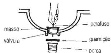
Coloque a porca e a guarnição pela parte inferior do lavatório, fixando-a com o parafuso.
