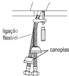
**Obs.: Para a linha Link e Unic as duas ligações flexíveis já vem conectadas de fábrica, por dentro do tubo.**
