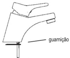
Encaixe a guarnição no rebaixo existente na base do misturador.
