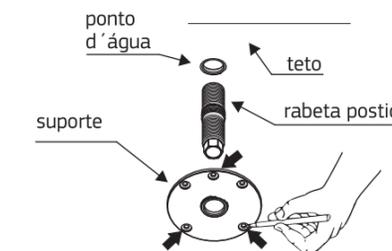
Antes de desrosquear, observe se o suporte ficou rente ao teto. Não se deve cortar a rabeta. A rabeta deve ficar saliente a parede no mínimo 76mm e no máximo 92mm.
