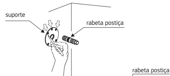
Antes de desrosquear, observe se o suporte ficou rente a parede. Não se deve cortar a rabeta. A rabeta deve ficar saliente a parede no mínimo 76mm e no máximo 92mm.
