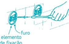
4) Posicione a canopla com o furo virado para baixo sobre o elemento de fixação e encaixe a barra no mesmo, fixe-os apertando os parafusos com o auxílio da chave allen.
