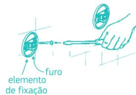
**3** Posicione as canoplas com o **furo virado para baixo sobre os elementos de fixação** e encaixe o suporte nos mesmos, fixe-o apertando os parafusos com o auxílio da chave allen, conforme desenho abaixo:
