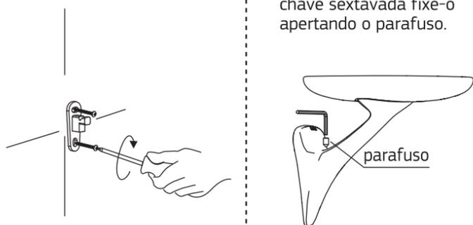
Posicione o acessório sobre o suporte e com auxílio da chave sextavada fixe-o apertando o parafuso.
