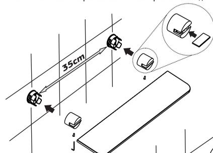
Posicione as chapas plásticas nas fendas e coloque cuidadosamente o vidro, fixando-o apertando os parafusos inferiores utilizando a chave sextavada que acompanha o produto, nos dois lados.
