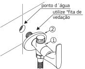
Rosqueie o flexível (3) no corpo (1), não esqueça de colocar a guarnição (4). Se o ponto de áqua não for exclusivo para ducha, retire o tampão do registro e rosqueie o flexível.
