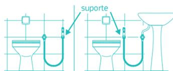
**5** Em seguida posicione o suporte e marque o furo inferior, retire o suporte e faça a furação. Por último encaixe o suporte fixando-o com o parafuso inferior.
