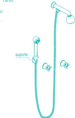
Nota: Os registros não acompanham o produto. Em seguida posicione o suporte e marque o furo inferior, retire o suporte e faça a furação. Por último encaixe o suporte fixando-o com o parafuso inferior.
