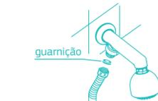
4- Coloque a guarnição e rosqueie a ducha manual no flexível, conforme desenho abaixo.
