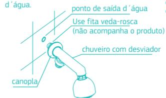
2- Ajuste a canopla até encostar na parede.
