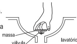
Coloque a porca e a guarnição pela parte inferior do lavatório, fixando-a com o parafuso.
