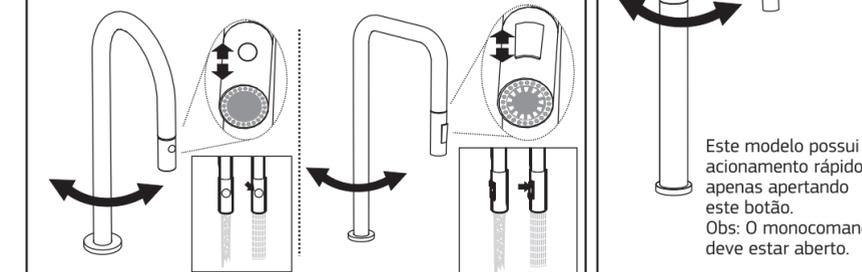
Regule a vazão e a temperatura da água na alavanca, conforme figuras abaixo.
