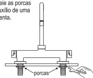
O misturador deverá ser conectado aos pontos de saída de água através de uma ligação flexível, preferencialmente Decca, que contém em sua embalagem as informações necessárias para sua instalação.
