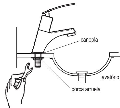
Remova o excesso de massa e instale a ligação flexível (não acompanha o produto) preferencialmente DECA que contém as instruções de instalação.
